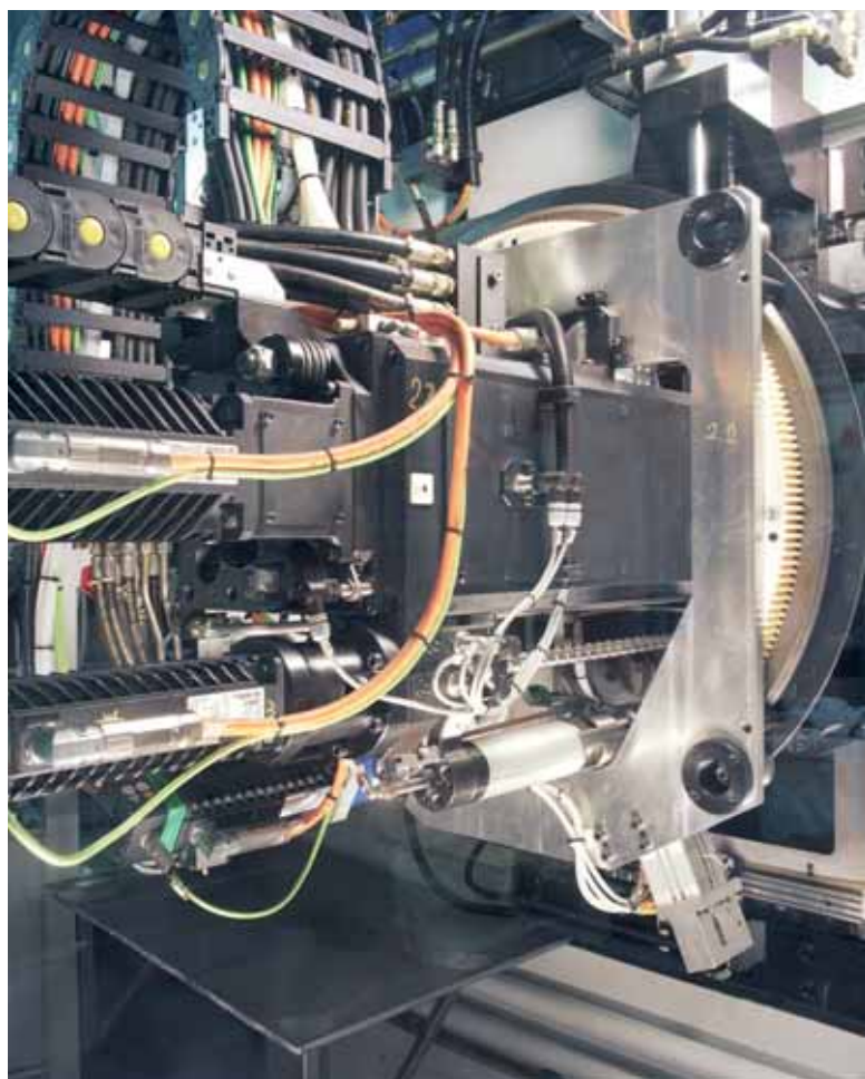
Modulo di lavoro con cambio utensile per Transfer e Multicenter.
